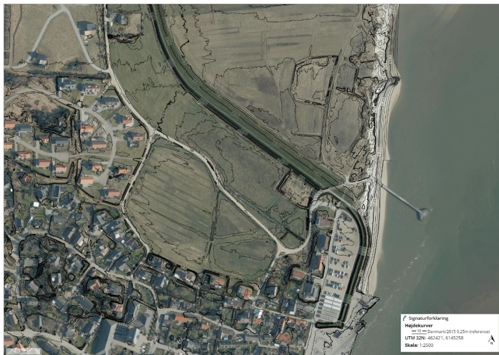
Figur 9-2. Sydligste del af det nordlige dige om Nordby. Med sort er angivet højdekurver med 0,25 m. ækvidistance.
