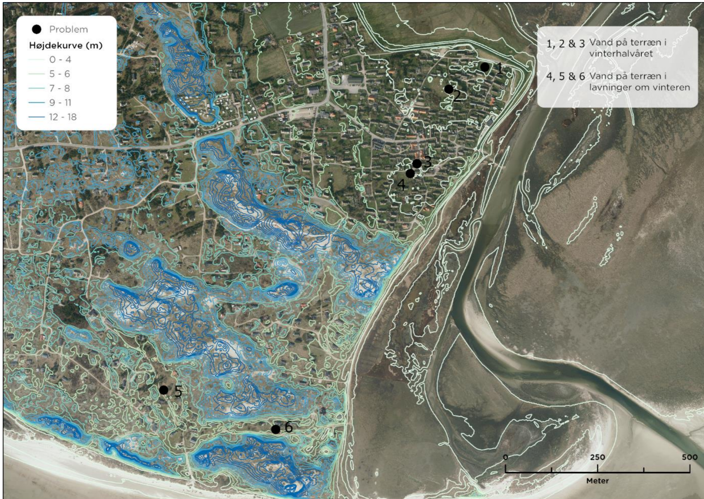
Udpegede problemområder med højtstående grundvand i vinterhalvåret.
