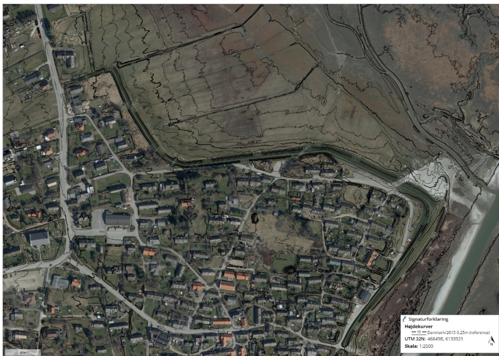
Figur 9-7. Den nordligste del af diget omkring Sønderho. Med sort er angivet højdekurver med 0,25 m. ækvistand.
