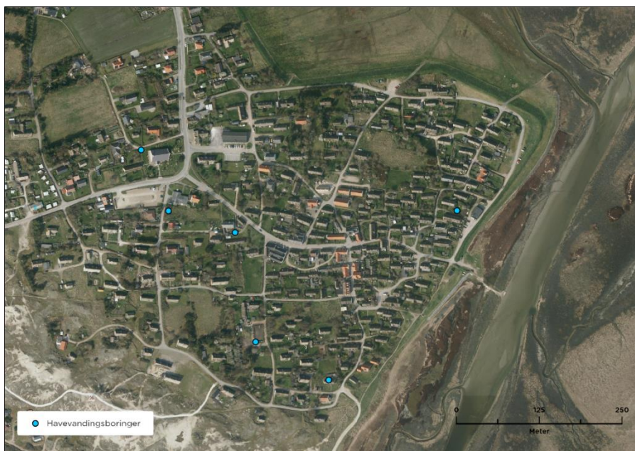
Figur 16 Haveboringer i Sønderho, som kan anvendes i et monitoringsprogram
