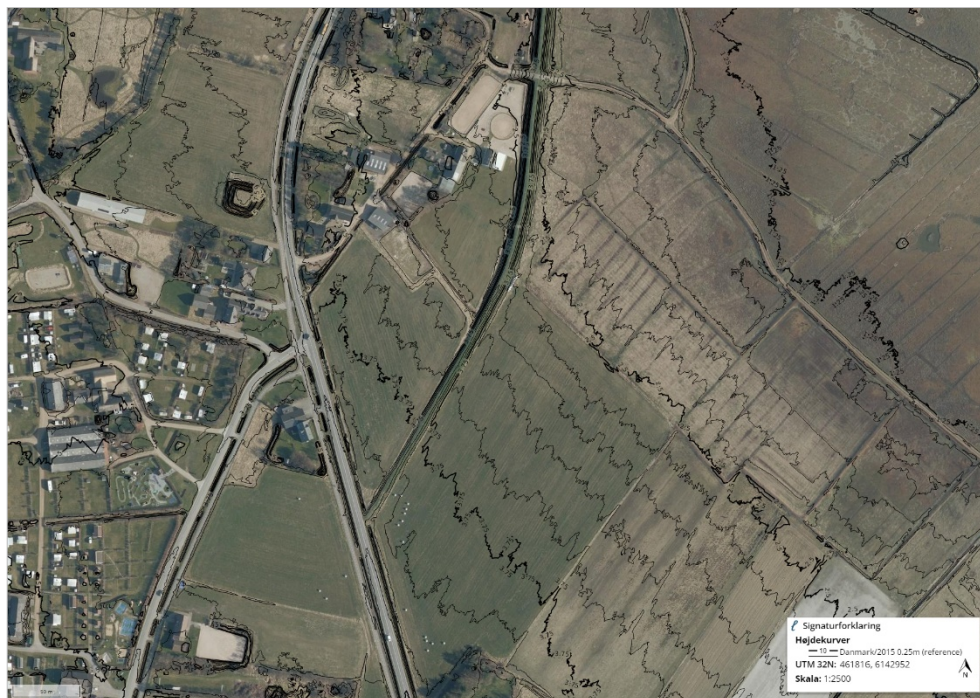
Figur 9-6. Sydligste del af det sydlige dige om Nordby. Med sort er angivet højdekurver med 0,25 m. ækvidistance.
