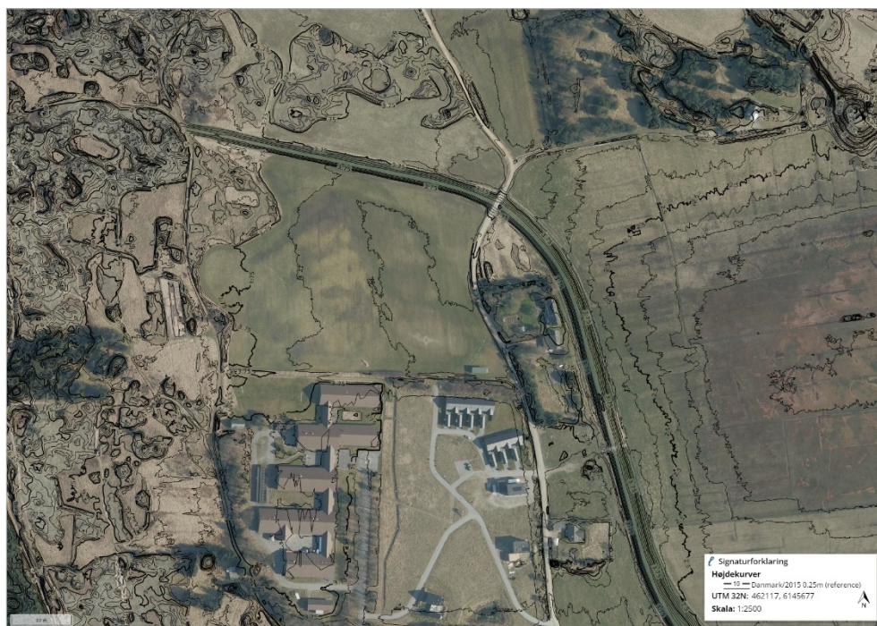
Figur 9-1. Nordligste del af det nordlige dige om Nordby. Med sort er angivet højdekurver med 0,25 m. ækvivalens.
